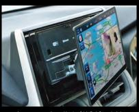
モニターユニットのサイズは240×141mm。 画面はハニカム構造として剛性を高めている。 また左右前後の角度調整と奥行き、上下の高さ 調整が可能。ナビは、緊急情報を受信すると自 動的に切り変わるなど、充実の内容だ。
